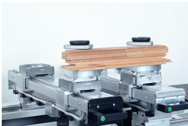
Механический зажим VCMC-B-QUICK при зажатии деталей рамы
